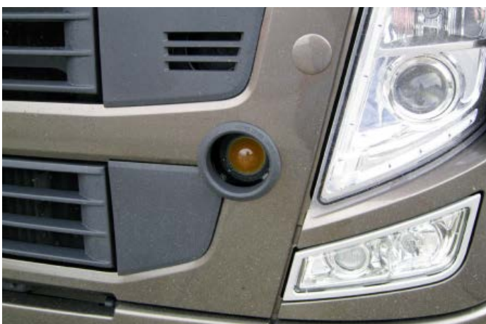
Der Sensor des Abstandsregeltempomats misst die Distanz zum Vordermann (Bildmitte)
