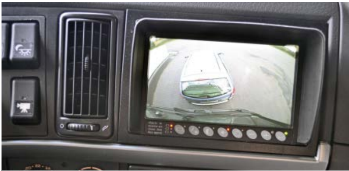
Die Frontkamera zeigt, was vorm Fahrerhaus im Toten Winkel liegt
