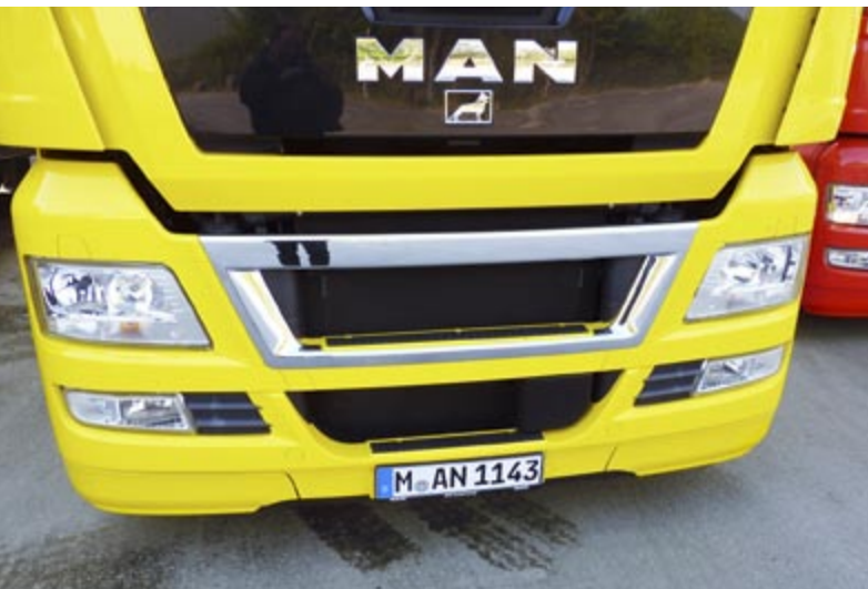
Anstelle eines schlicht rechteckigen Kühlergrills glänzt in der Mitte des TGX eine massive Maske – die Kühlluft findet darunter Zugang zu den diversen Wärmetauschern
