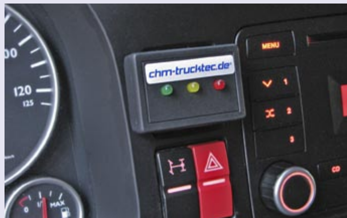
Die nachgerüstete Ampel-Anzeige im Cockpit gibt dem Fahrer den Hinweis, ob er im optimalen Drehzahlbereich fährt
