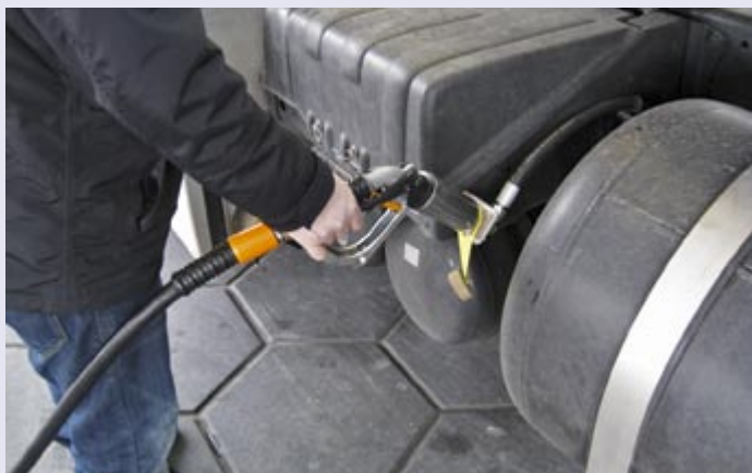
Gas tankt sich etwas anders als Diesel. Hier muss die Zapfpistole mit dem Einfüllstutzen verriegelt werden
