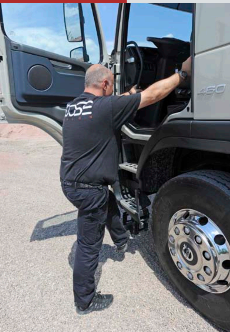
Die bewegliche untere Trittstufe sorgt für einen bequemen Einstieg
