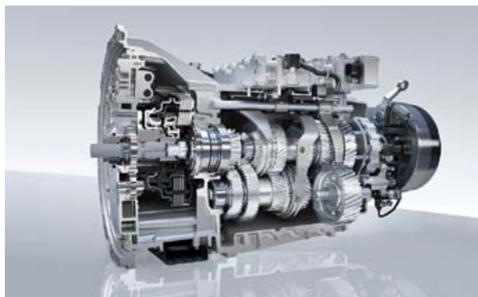
Schnittmodelle des Doppelkupplungsgetriebes Duonic. Es besteht aus zwei Teilgetriebe mit versetzt arbeitenden Kupplungen
