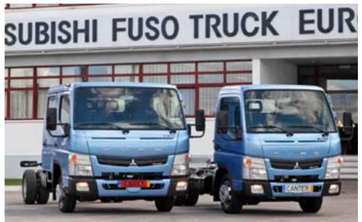
Größenvergleich: Links die Comfort-, rechts die neue kleine Standard-Kabine (Breite:1995/1695 mm)
