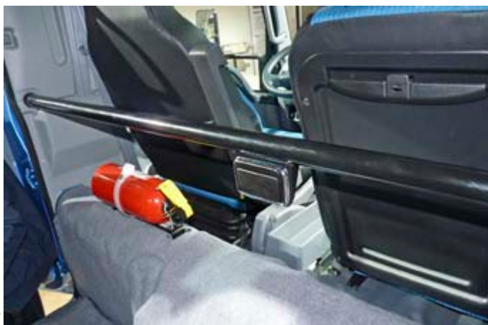
Auf der Rücksitzbank einer DoKa. Die Mittelstange und der große Bodenträger dienen der Stabilisierung der Kabine
