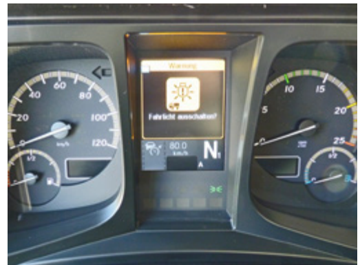
Das Display warnt den Fahrer und mahnt ihn gegebenenfalls, das Licht auszuschalten
