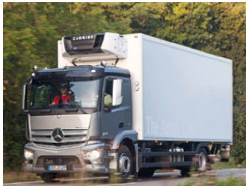
Den Antos gibt es mit den verschiedensten Aufbauten. Hier ein 1840iger mit Kühlkoffer
