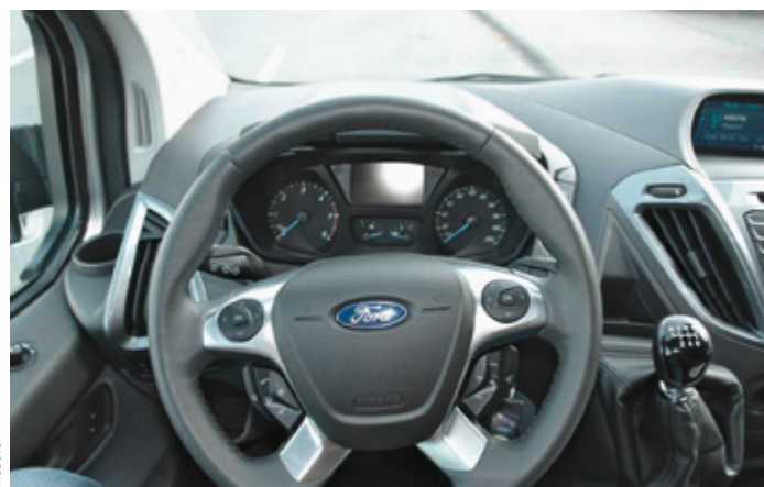
Über ein Multifunktionslenkrad kann der Kraftfahrer mehrere Fahrzeugfunktionen, wie Tempomat oder Limiter aktivieren
