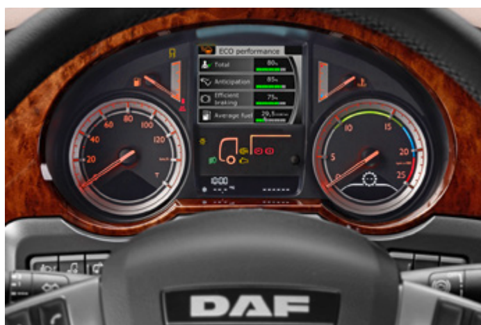
Die Instrumententafel kommt im Stil der Zeit mit eingebautem „elektronischen Fahrlehrer“
