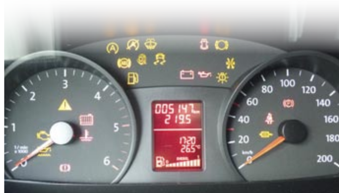
Kontrolle der Kontrollleuchten: Mit der Zündung leuchten alle Symbole im Display kurz auf
