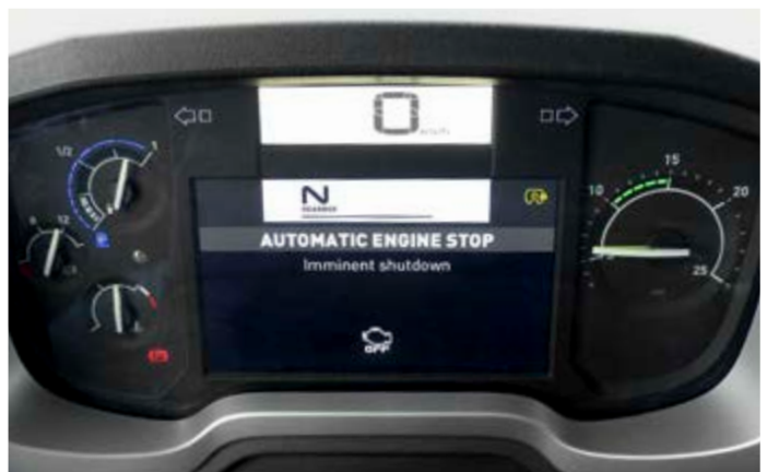
Bei der Funktion „Motorstopp“ schaltet das Triebwerk im Leerlauf nach drei bzw. fünf Minuten ab
