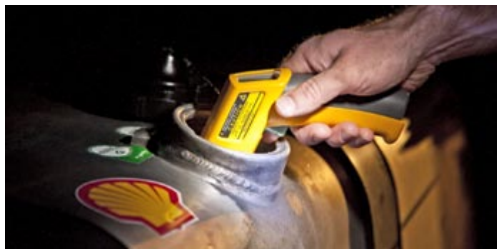
Die Kraftstofftemperatur wird gemessen. Bevor es auf Testfahrt geht, sollte der Diesel eine bestimmte Temperatur erreicht haben
