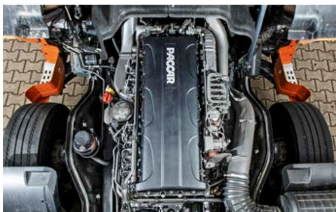
Der Sechszylinder erreicht seine Nennleistung und zugleich sein maximales Drehmoment bereits bei 1450/min<sup>-1</sup>
