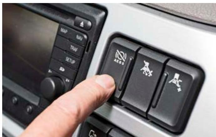
Das Advanced Emergency Braking System (AEBS) bremst das Fahrzeug im Notfall selbstständig und – falls erforderlich – vollständig ab
