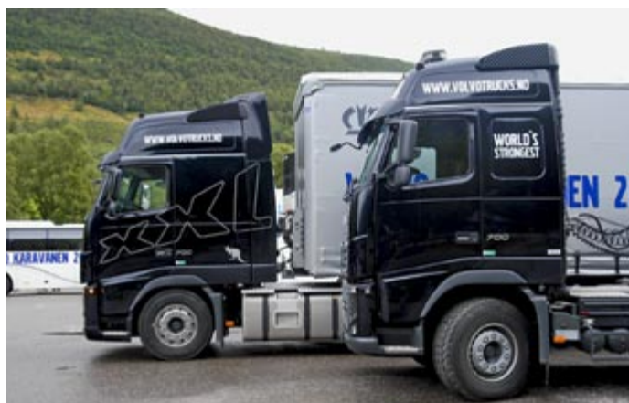
Der „Australier“ (hinten) hat eine um 245 mm verlängerte Kabine
