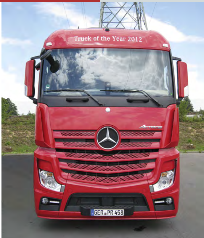
Der Test-Lkw ist mit dem Streamspace-Fahrerhaus versehen. Diese Kabine gilt nach Herstellerankunft als die strömungsgünstigste unter den großvolumigen Behausungen
