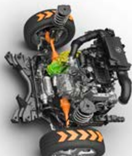
Schematische Darstellung des Vorderradantriebs beim Vito
