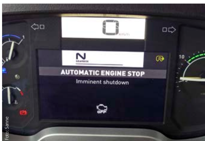
Das Feature Automatic Engine Stop verhindert unnötig lange Leerlaufzeiten des Motors und trägt so zur Kraftstoffersparnis bei
