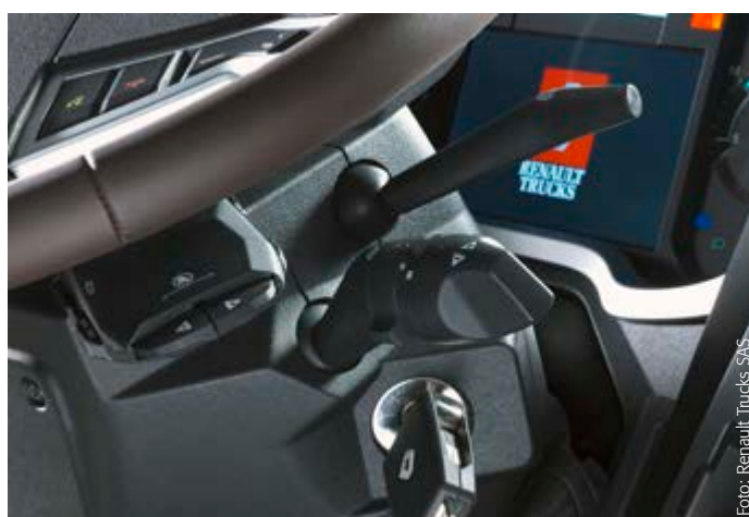
Der „Satellit“ zur Radiobedienung sitzt nach wie vor griffgünstig rechts unterhalb des Lenkrades
