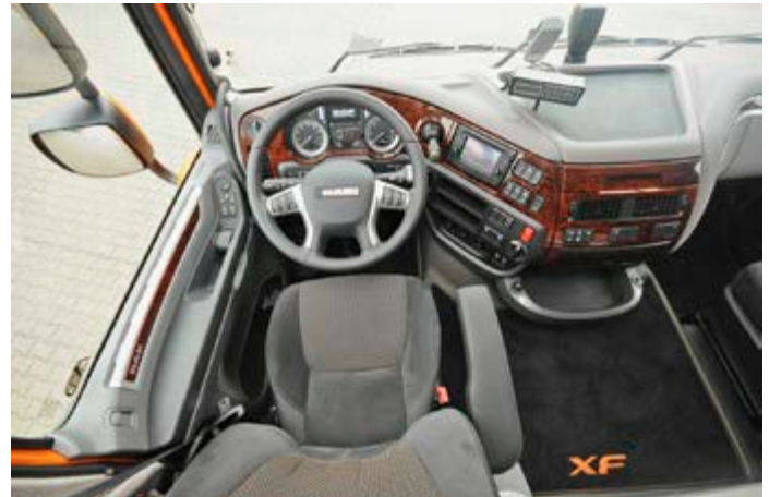
Der Arbeitsplatz ist aufgeräumt und die Zusammenfassung von Bedientastern in übersichtliche Dreiergruppen erhöht die Zugriffssicherheit
