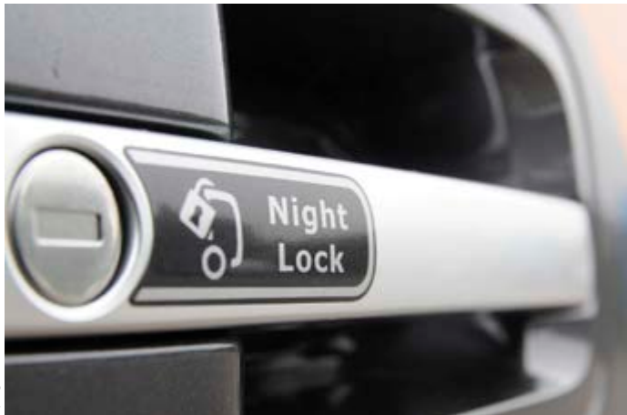
Die mechanische Verriegelung Night Lock soll Lkw-Fahrer des Nachts vor Einbrüchen und Raubüberfällen in ihren Fahrerhäusern schützen
