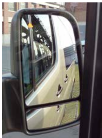
Der Totwinkelassistent warnt den Fahrer durch ein aufleuchtendes Dreieck im Außenspiegel (rot = Gefahr, gelb = nicht messbereit)
