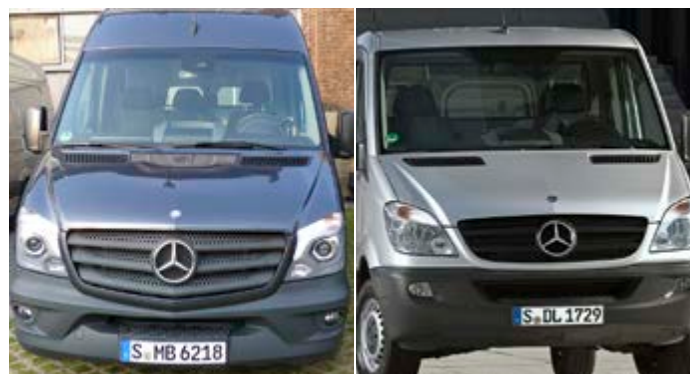
Die Front des Neuen (l.) ist wesentlich steiler gestaltet als beim Alten. Die Lamellen sind nun leicht gefeilt und gelocht
