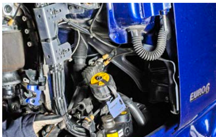
Eine manuelle Kontrollmöglichkeit des Ölstandes ist direkt neben dem Einfüllstutzen gegeben
