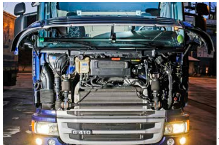
Das 410-PS-Triebwerk kommt ohne Abgasrückführung aus
