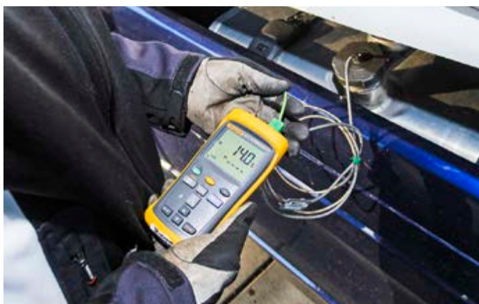
Für möglichst exakte Verbrauchsfahrten wird die Temperatur des Diesels vor und nach den Touren überprüft
