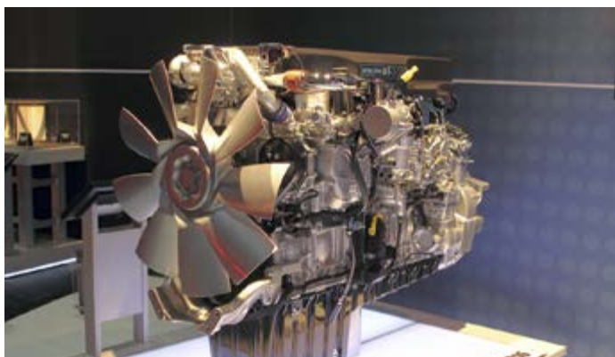
Daimlers Weltmotor OM 473, der unter der Bezeichnung DD16 in den USA schon länger läuft, treibt den neuen Arocs an
